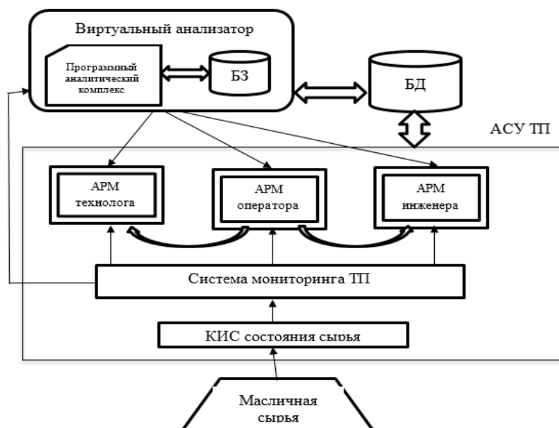
Рис. 1. Схема взаимодействия АСУТП и ВА
