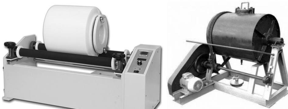
Рис. 1. Модель роlikоопорной лабораторной мельницы (слева) и мельничной цилиндро-осевой опорной (справа)
