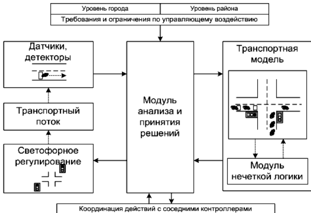
Рис. 1. Структурная схема координированного дорожного контроллера с модулем нечеткой логики
