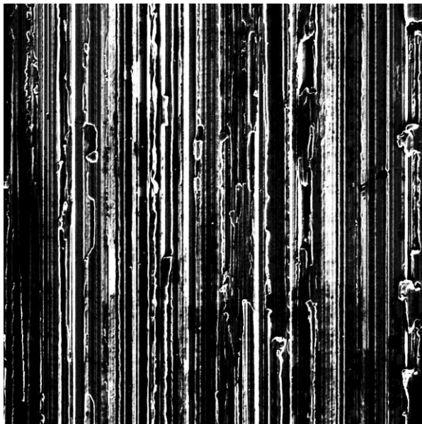
Сталь 45Х до испытаний. Увеличение 2000х
