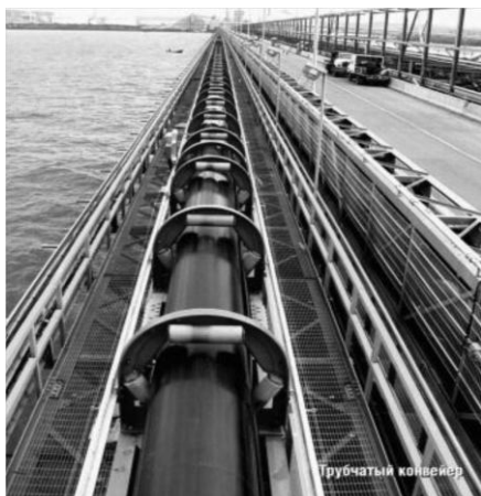
Рис. 2. Трубно-ленточный конвейер фирмы КОСН
