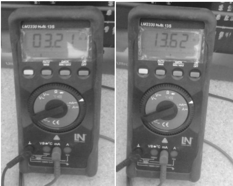
Рис. 5. Показание амперметра сизменением числа проходимых тросов РТЛ
