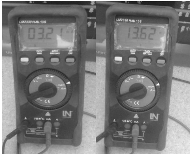
Рис. 5. Показание амперметра с изменением числа проходимых тросов РТЛ
