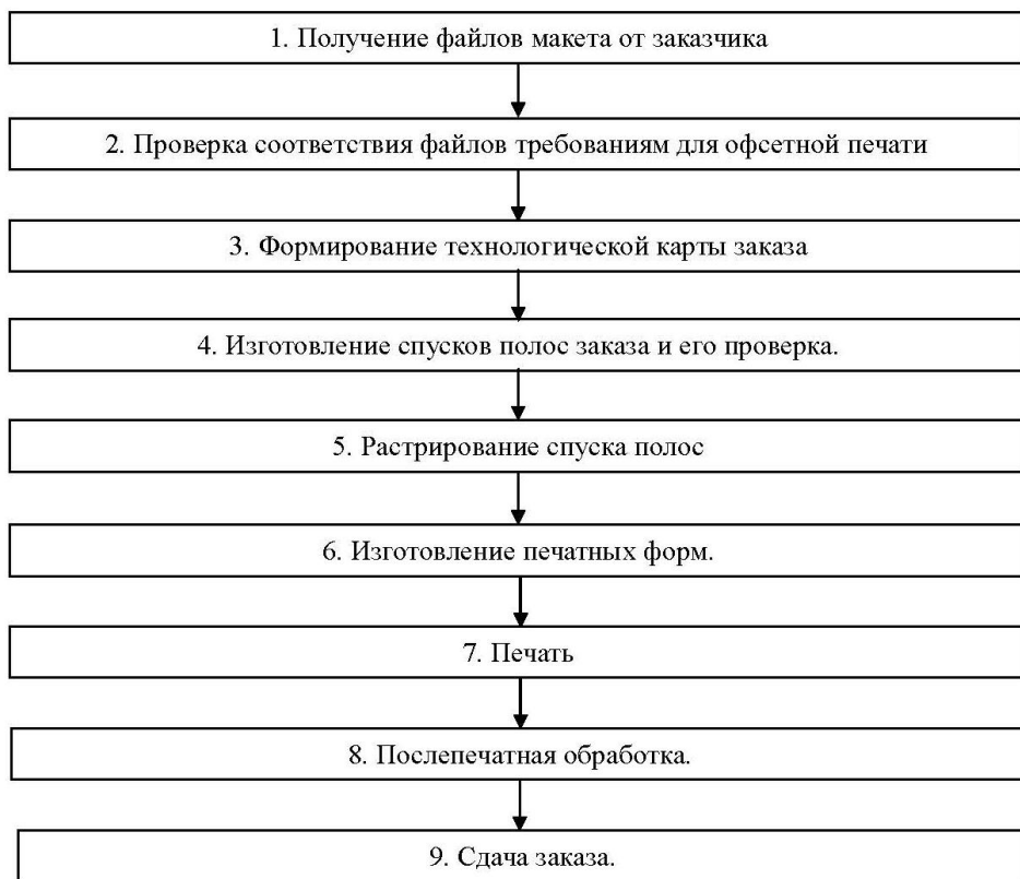
Рис. 1. Упрощенная технологическая схема обработки поступившего в производство заказа
