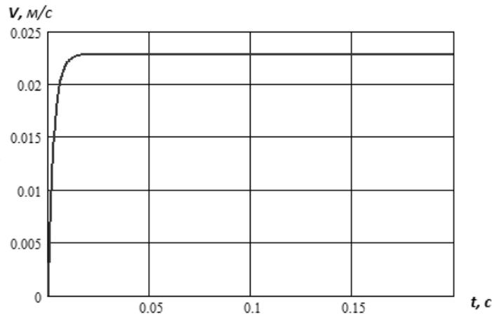
Рис. 5. Зависимость скорости шарика радиусом 0,79 мм от времени
