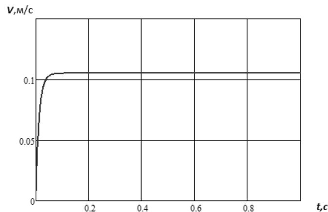
Рис. 4. Зависимость скорости шарика радиусом 1,985 мм от времени
