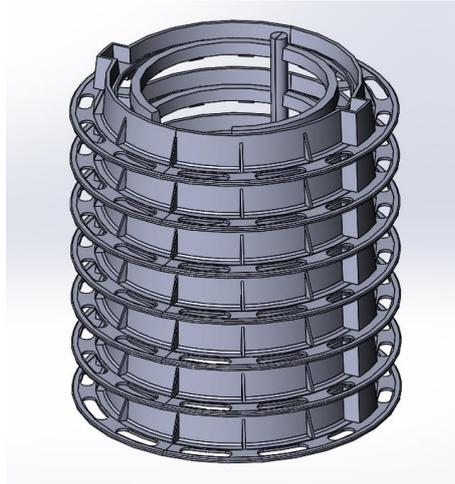
Рис. 3. 3D-модель готовой отливки корпуса люка
